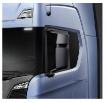
Подогрев зеркала заднего вида Зеркала заднего вида с электрической регулировкой Широкоугольное зеркало заднего вида
