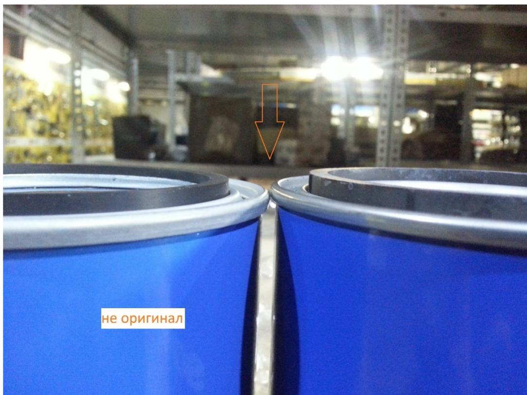
4. Верхняя пластина сильно отличается. Отверстия подачи топлива, у не оригинального фильтра, немного больше в диаметре. Казалось-бы проток должен быть лучше, но, когда мы заглянем внутрь фильтров – этот плюс полностью исчезнет.
